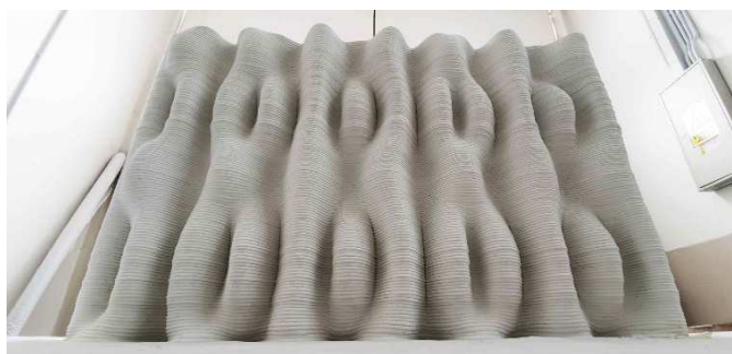
Figure 12: Les murs modulaires d'impression 3D en béton.
