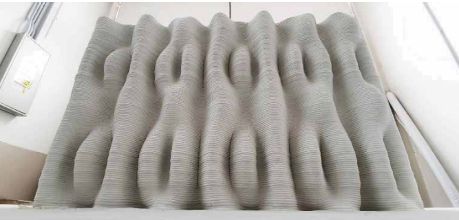
الشكل 12: الجدران المعيارية للطباعة الخرسانية ثلاثية الأبعاد ، تصوير لؤي كردي ، 2019.
